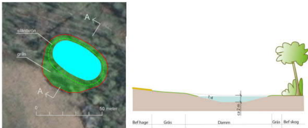
Figur 7. Plan och profilskisser över den planerade dammen 5
